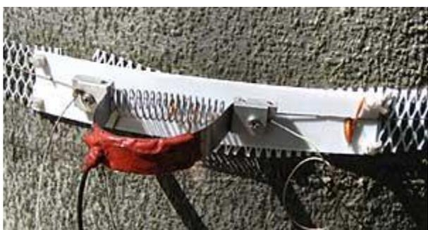
Figure 6 : Dendromètre, appareil mesurant en permanence la circonférence de l'arbre (source : <http://www.waldwissen.net/>)
