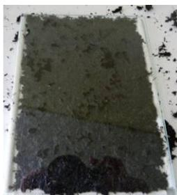
4. Placer les fonds des deux sous-verre de part et d'autre des deux plaques vitrées. Maintenir l'ensemble avec 1 ou 2 gros élastique(s)
