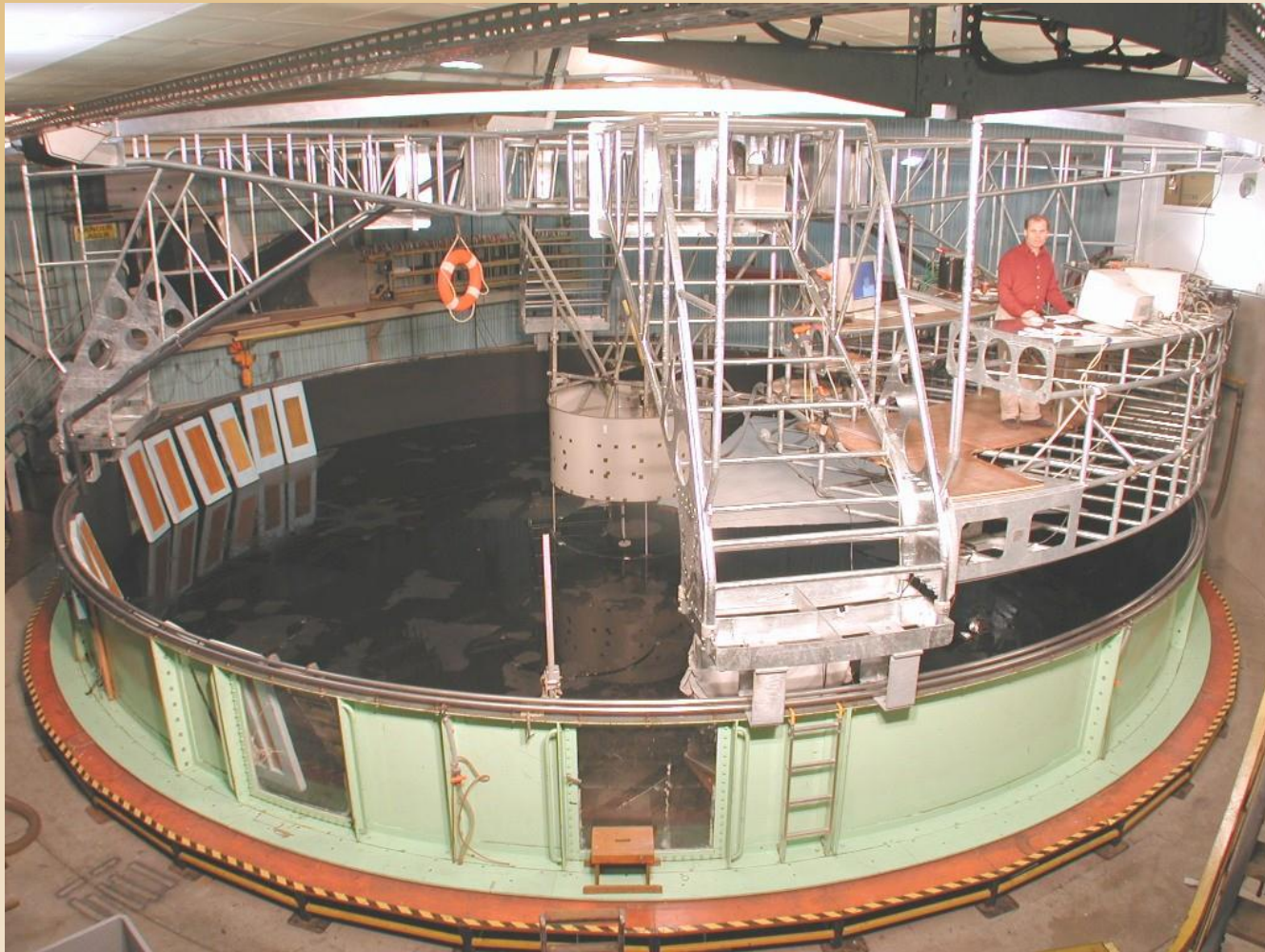
Plateforme tournante de Coriolis (Grenoble)
