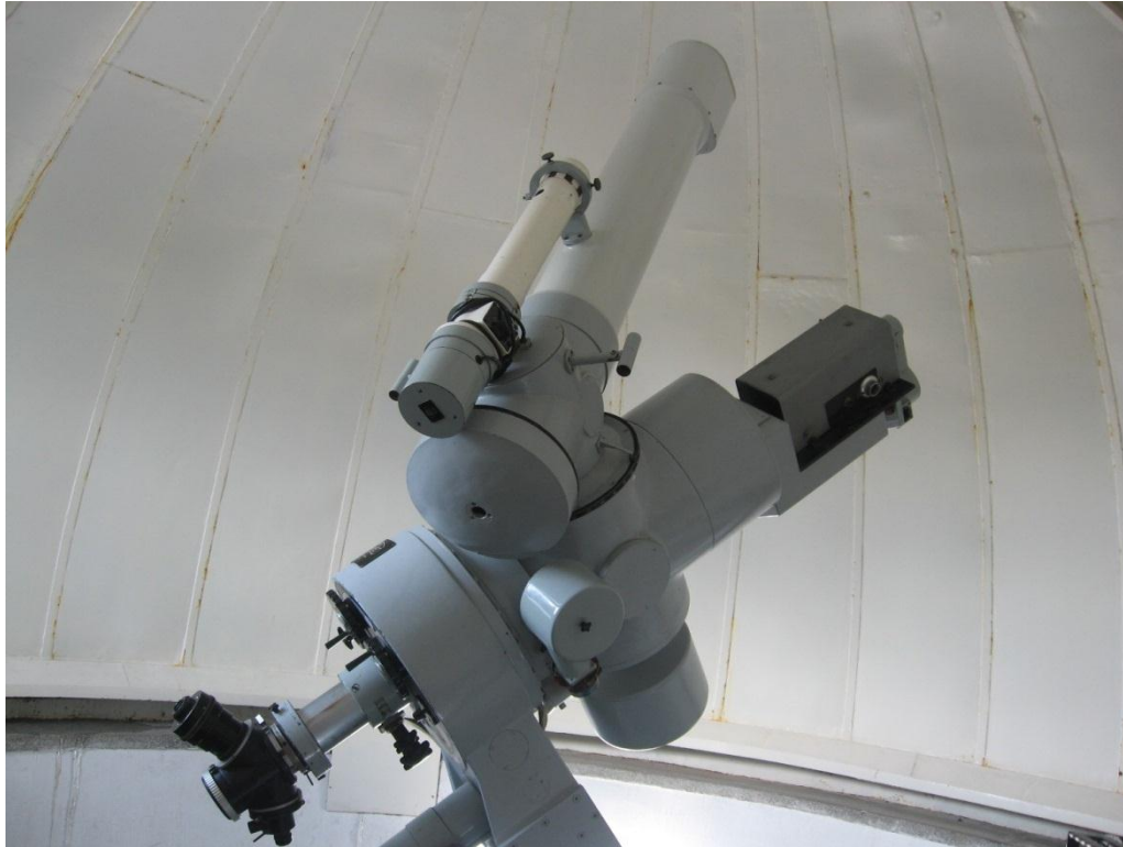
Lunette coudée Zeiss de type Loewy inversé à l'observatoire d'Ankara pour l'observation du Soleil. Une semblable pour Radebeul près de Dresde (1969)
